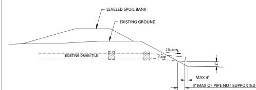
SURROUNDING GROUND SHAPED TO DRAIN TO PIPE. THIS WORK IS INCIDENTAL TO THE SPOIL BANK LEVELING.
